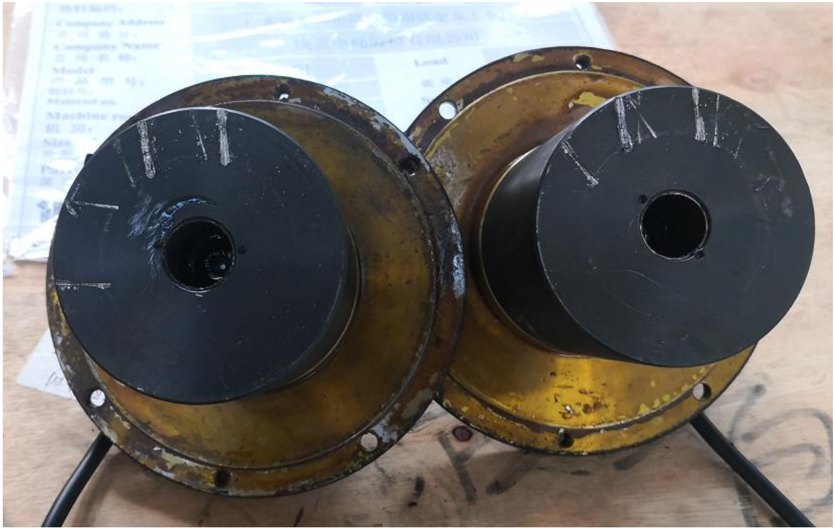
600 次手动松闸试验后的铁芯端面
